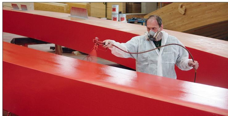
Die markante Farbe wird bei Wiehag auf die langen Teile mit Spritztechnik von Wagner aufgebracht Fotos: Wagner
